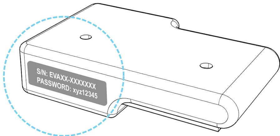
**Bild 59** Typenschild am EMS (Beispiel)
