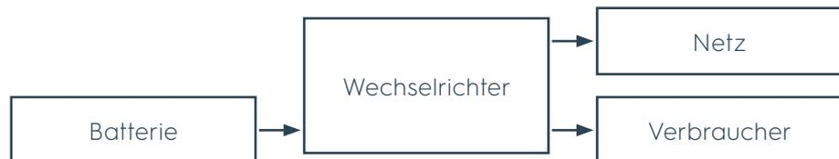
**Bild 28** Energie aus der Batterie ausreichend, überschüssige Energie ins Netz
