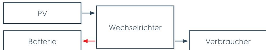
**Bild 22** Solarenergie ausreichend, überschüssige Energie für Batterieladung
