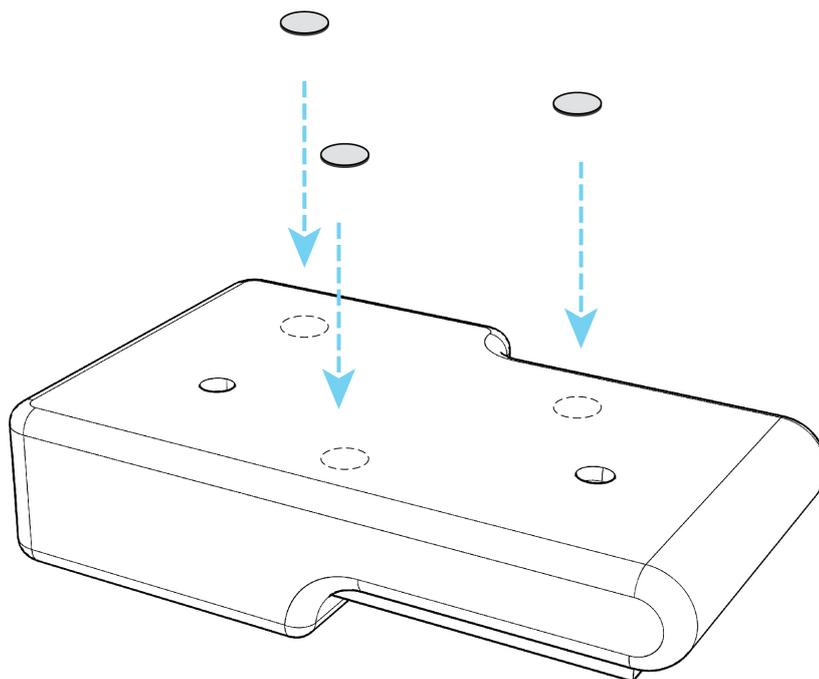
**Bild 60** Befestigung über Magneten
