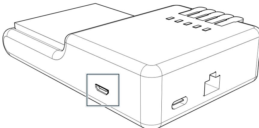
**Bild 61** EMS mit dem Wechselrichter verbinden
