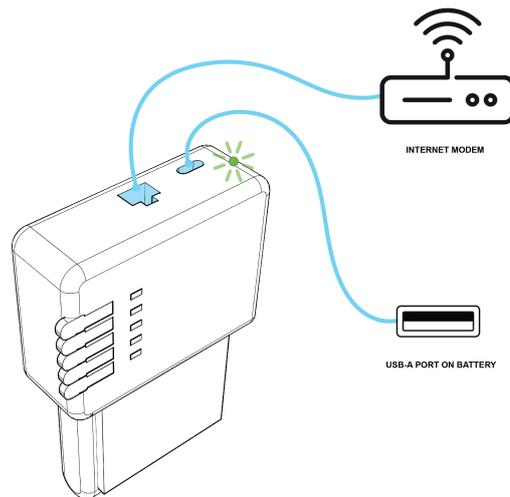
**Bild 62** EMS mit der Stromversorgung verbinden
