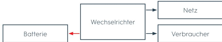
**Bild 27** Energie für Batterieladung aus dem Netz
